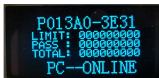
圖 3.2-5 HC-PM18-V5 顯示幕確認晶片型號及晶片特徵碼
