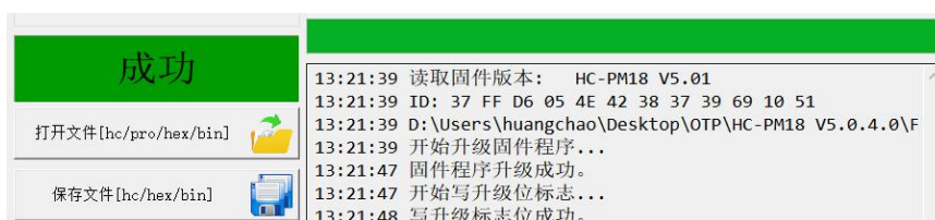
圖 5-3 固件更新成功，請耐心等待 HC-PM18-V5 硬體重定，蜂鳴器 “滴” 一聲後燒錄器固件更新成功
