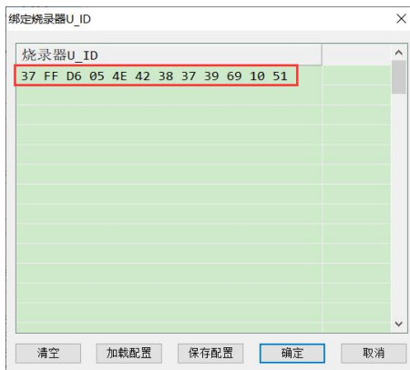
圖 4.6-5 “綁定燒錄器 U_ID” 設置對話方塊，設置後燒錄檔只允許下載至指定燒錄器（設置前連接 HC-PM18-V5，進入設置對話方塊後會自動讀取並填寫好 U_ID）
