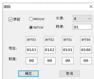
圖 4.4-2 滾碼配置對話方塊，配置“使能”、“MOVLW”、“RETLW”、長度、跨度、位址、資料
